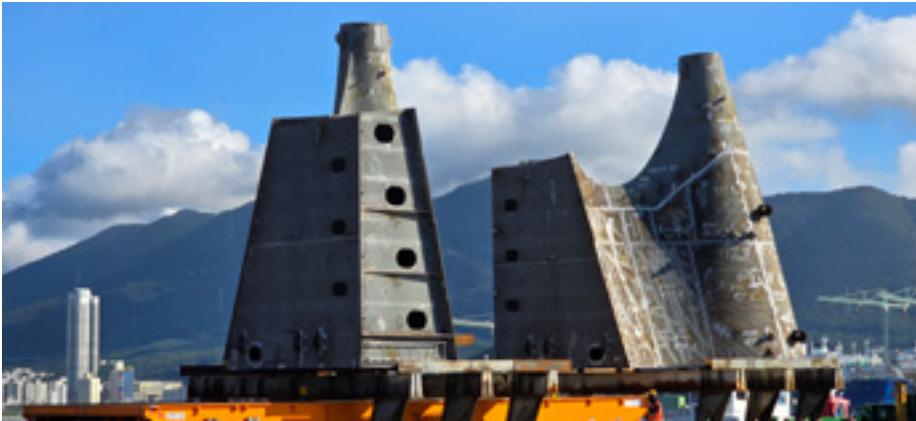
제이엘중공업은 다양한 선종(LNG Carrier, Oil Tanker, Bulk Carrier 등)의 Stern Boss를 제작하며, 고품질 용접 및 정밀 가공을 통해 고객의 요구사항을 충족시킵니다.
