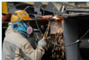
선체 상부구조 블록은 외판 블록에 비하여 비교적 박판으로 구성되며 이 블록은 갑판 캠버(CAMBER)로 인하여 약간의 경사가 있으므로 곡 블록의 조립과 같은 방법을 사용합니다.
