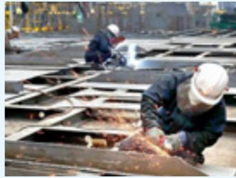
선저판, 선측판, 격벽판 등과 같이 평면의 판재에 녹골을 취부하는 평블록은 컨베이어 위에서 판재를 이어붙여 블록크기로 평판을 조립하고 그 위에 녹골재를 취부합니다. 이 작업에서는 전용 조립장치를 사용하여 자동으로 취부하고 용접합니다. 녹골재를 취부한 후에 녹골재와 직각방향으로 플로어(FLOOR)를 취부하여 격자형식으로 블록이 보강되도록 합니다.
