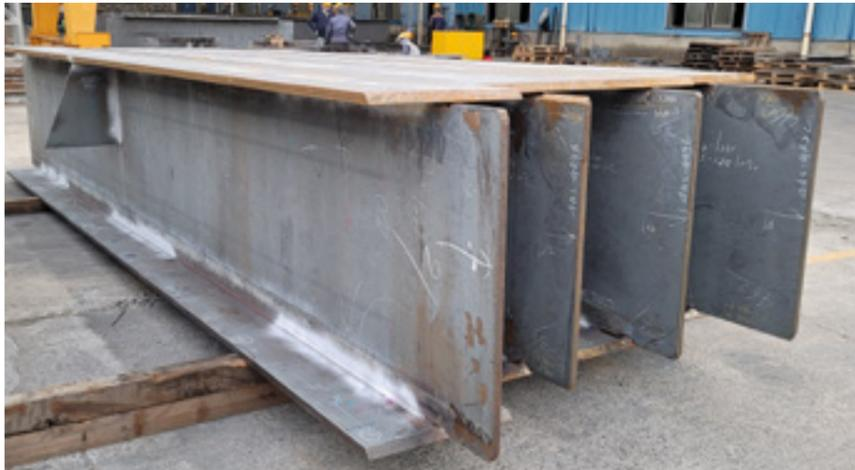
용접 플레이트 거더는 제조 용이성과 효율성으로 인해 건설에 가장 일반적으로 사용되는 거더 유형입니다. 매우 견고하며 측면 움직임에 저항하면서 매우 높은 하중을 견딜 수 있습니다.
