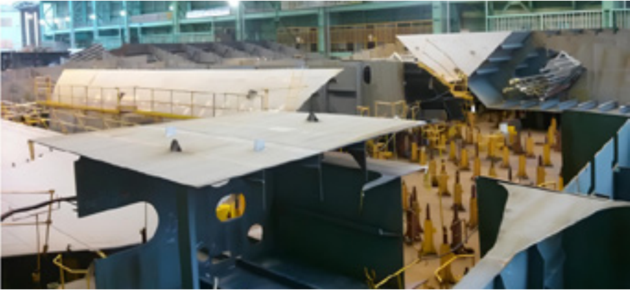
子块组装分为三个过程：组装平面块、弯曲块和船体上层结构块。
