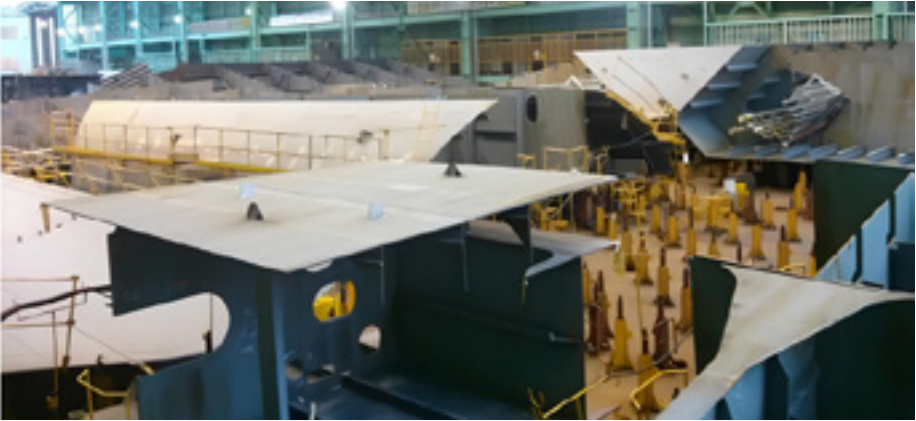
子块组装分为三个过程：组装平面块、弯曲块和船体上层结构块。
