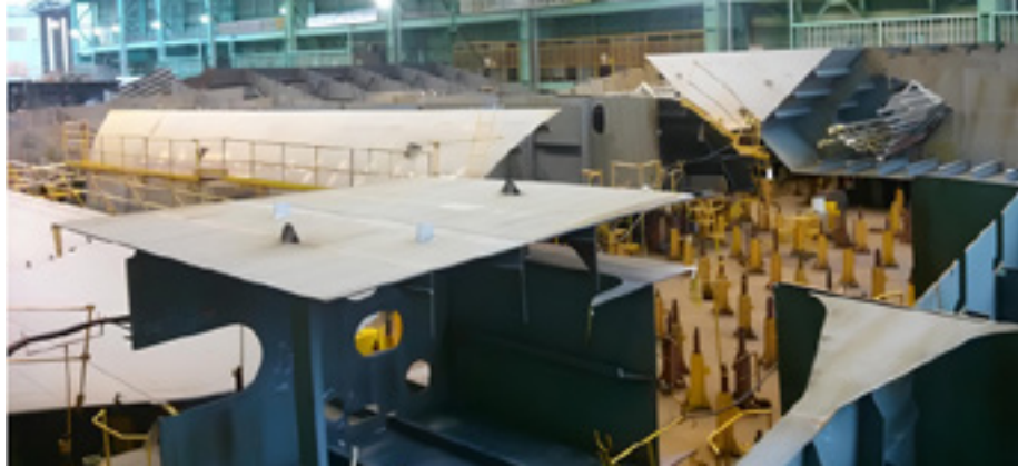
중조립은 평 블록, 곡 블록, 선체 상부구조 블록을 조립하는 3개의 과정으로 나뉩니다.
