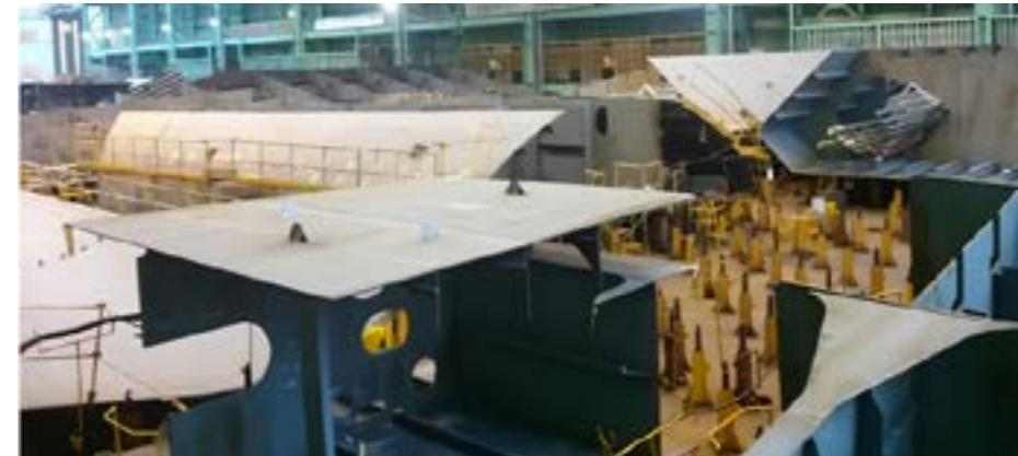
يتم تقسيم تجميع الكتل الجزئية إلى ثلاثة عمليات: تجميع الكتل المسطحة، الكتل المنحنية، وكتل الهيكل العلوي.
